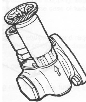
HIGH PRESSURE LIFT PUMP (ALL TURBO ENGINES)
