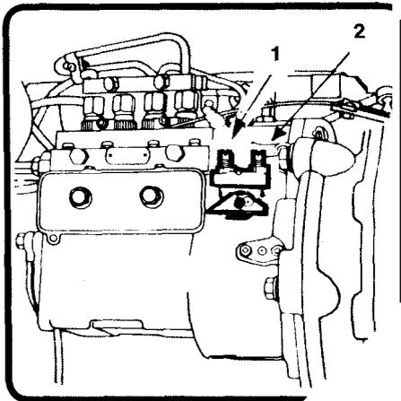
INJECTION PUMP (TURBO ENGINES)
