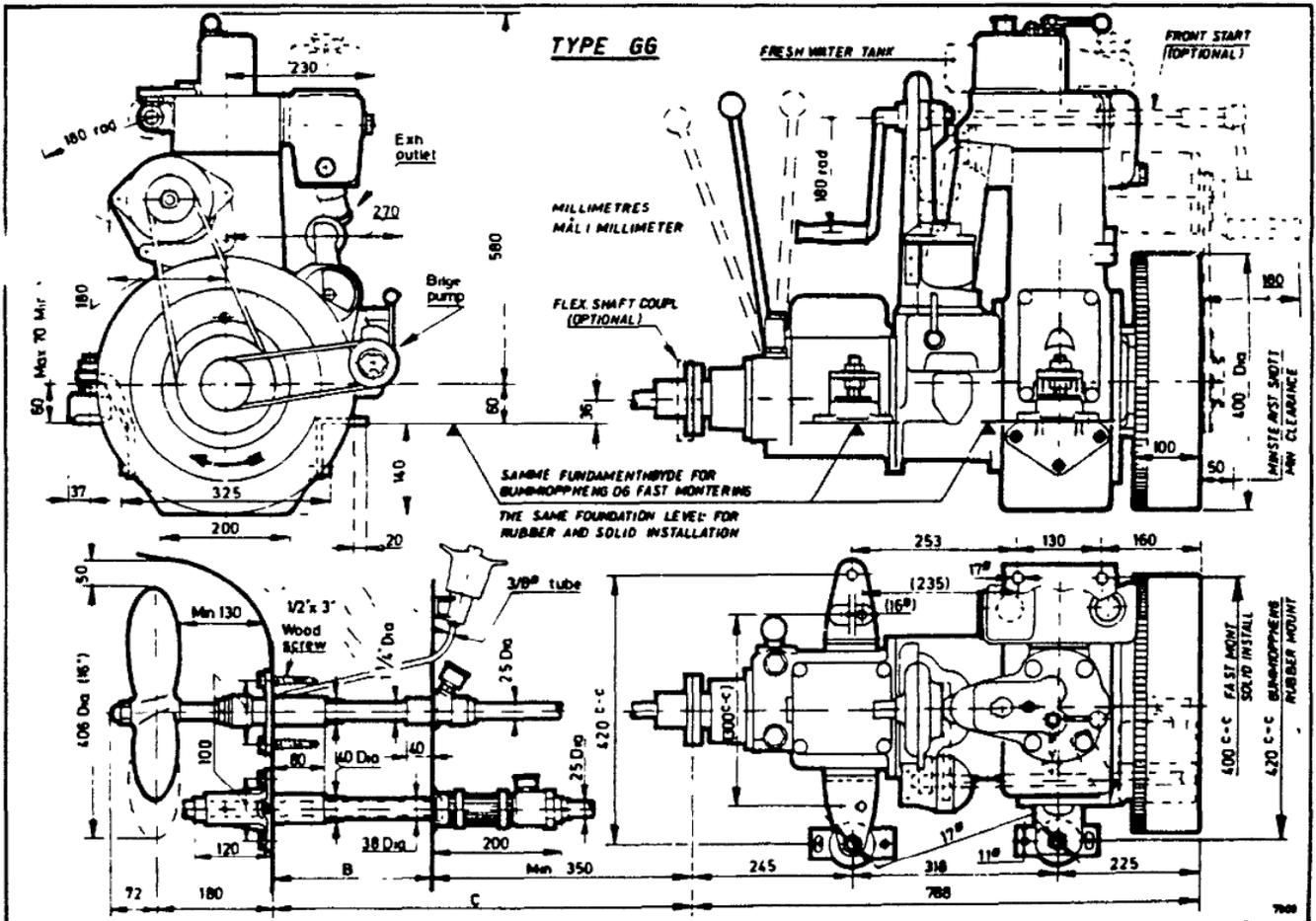
SNITT GJENNOM 10 HK SABB DIESEL, TYPE G
