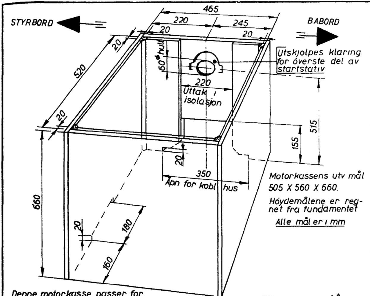
Denne motorkasse passer for motor m/vekselstrømsdynamo
