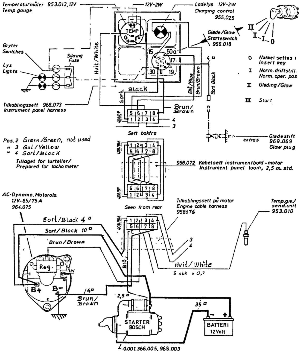
Koblingskj. for starter, dynamo 12V - 75A, ladelys, glødestarteswitch.
